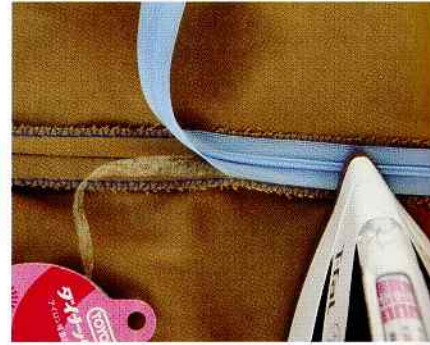
4. 両面接着テープをあき止まりまではさみ、アイロンで接着する。
