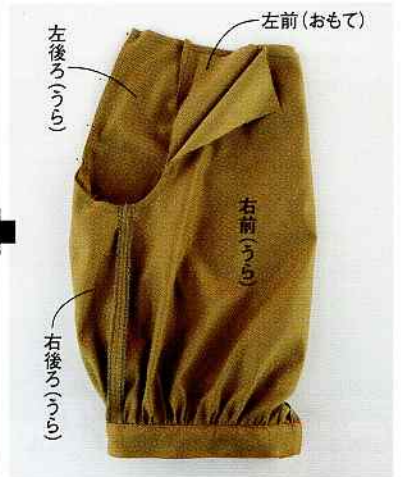
1. 右パンツと左パンツのおもて同士を合わせて、股ぐり線をミシンで縫う。縫い代はジグザグミシンで始末する。
